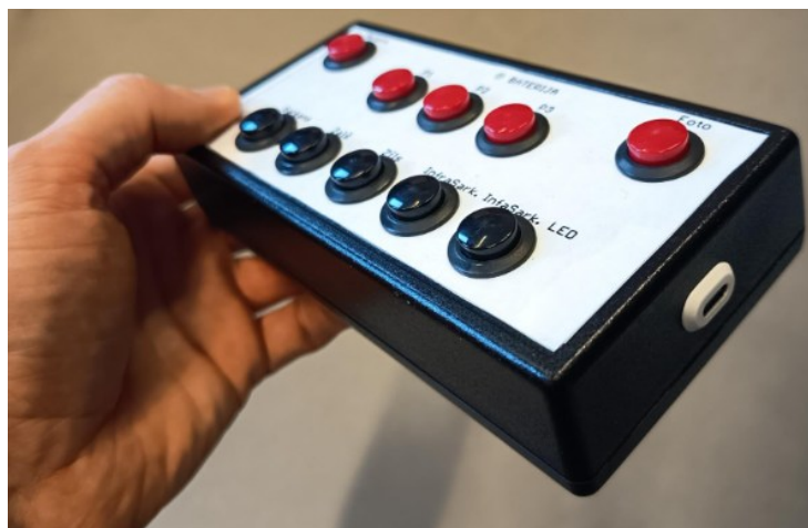
3. att. Vadības pulsts – korpusa labajā pusē USB-C ligzda iebūvētā akumulatora uzlādei.
