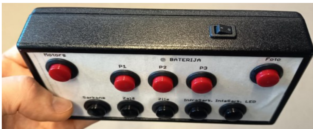
4. att. Vadības pulsts – korpusa augšpusē ieslēgšanas slēdzis (izslēgts – pozīcija “0”).
