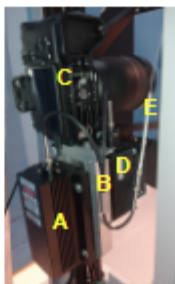
2. attēls. A - 850nm lāzers; B - Y veida šķiedra; C - fotokamera; D - RGB lāzers E - sānstarojošā šķiedra
